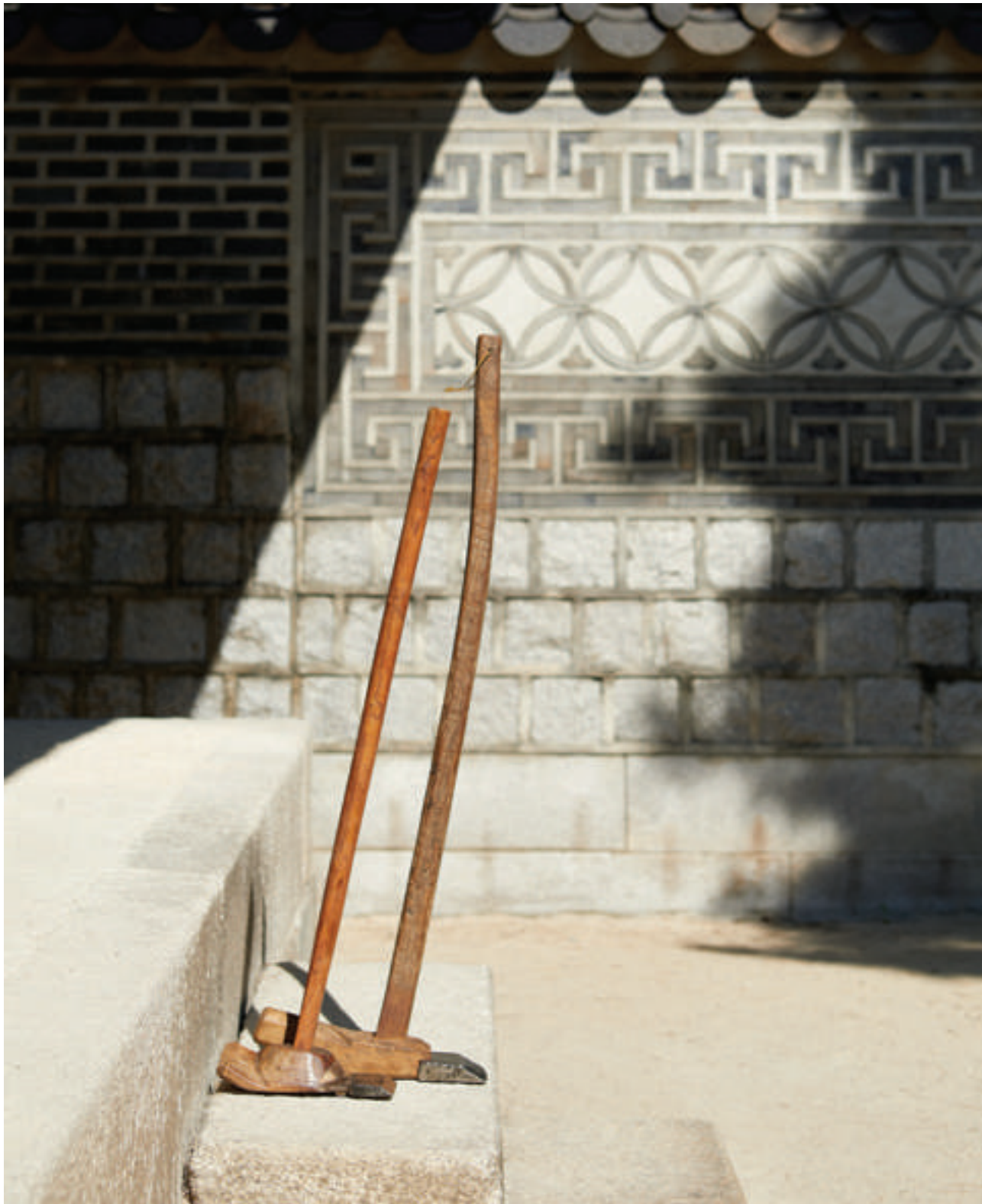
큰자귀는 기둥이나 보의 재료가 되는 나무를 쓰임에 맞게 다듬는 구실을 한다. 큰 집을 짓는 대목수에게 없어서는 안 될 연장이자, 대목수의 일 자체를 상징하기도 한다. 이곳 운현궁에서도 큰자귀가 열심히 일했을 것이다.
